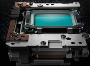
Die Olympus OM-D E-M5 Mark III ist mit dem bewährten Supersonic Wave Filter (SSWF) ausgestattet, der automatisch beim Einschalten der Kamera in Aktion tritt. Dabei wird der gesamte Bildsensor über Ultraschallwellen in Schwingungen versetzt, um mit mehr als 30.000 Vibrationen den Staub effektiv abzuschütteln.
