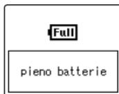
Visualizzato quando la batteria è completamente carica
