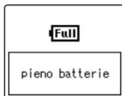
Visualizzato quando la batteria è completamente carica
