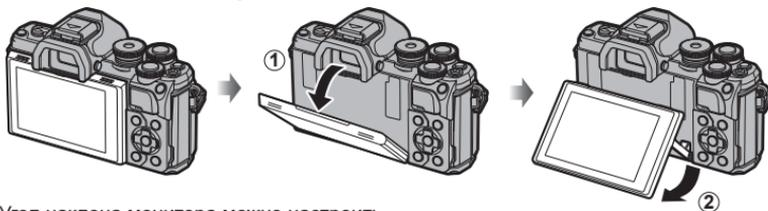
Угол наклона монитора можно настроить.
