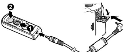
Rotați selectorul de moduri de pe telecomandă la **OFF** și conectați telecomanda la cameră prin cablul furnizat.
