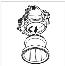
③ Немного ослабив PPO-E01, направьте его линзу вниз и продолжайте вращать против часовой стрелки, пока он полностью не отсоединится от бокса серии РТ-Е. Будьте осторожны, чтобы не уронить PPO-E01 или бокс серии РТ-Е.
