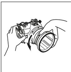
② Одной рукой крепко удерживая бокс РТ-Е, начните выкручивать PPO-E01, повернув его примерно на 90 градусов против часовой стрелки. Если PPO-E01 закреплен слишком туго и не выкручивается, оберните его куском резины или аналогичным нескользким материалом.
