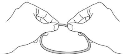
Retirer les matières étrangères collées à la rainure du joint en utilisant un chiffon propre ou du coton-tige. De même, retirez le sable ou les saletés susceptibles d'adhérer à la surface de scellage sur le joint du corps du caisson.
