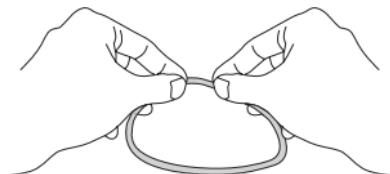
Odstranite sve strane tvari koje su se uhvatile za o-prsten pomoću krpe koja ne otpušta vlakna i pamučnim jastučićem. Također odstranite pjesak i nečistoću koja se uhvatila na kontaktnu površinu o-prstena s prednje strane poklopca kućišta.
