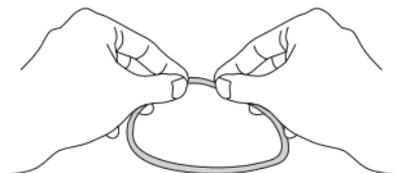
Remova o material estranho agarrado da ranhura do anel com um pano limpo ou um cotonete. Remova também toda a areia ou sujidade agarrada a qualquer superfície de contacto do anel na tampa dianteira da caixa.
