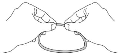
Skinite sve prilepljene strane čestice sa žleba O-prstena čistom tkaninom koja ne sadrži lan ili pamučnim tupferom. Takođe očistite sav prilepljeni pesak ili prljavštinu sa kontaktne površine O-prstena na prednjem poklopcu kućišta.
