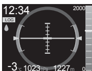
Τεχνητός ορίζοντας και υψόμετρο (βάθος)
