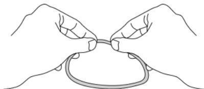
Usando un paño limpio sin hilos o un palillo algodónado, retire las materias extrañas fijadas a la ranura de la junta tórica. También retire la arena o el polvo de la superficie de contacto de la junta tórica (lado de la tapa de las pilas).
